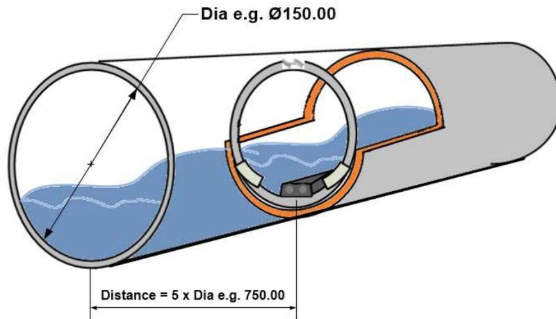
Требуемое расстояние в 5 диаметров от отверстия трубы
