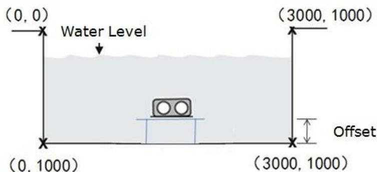
**Смещение (мм):** Данный параметр определяет расстояние между дном русла и положением датчика.
