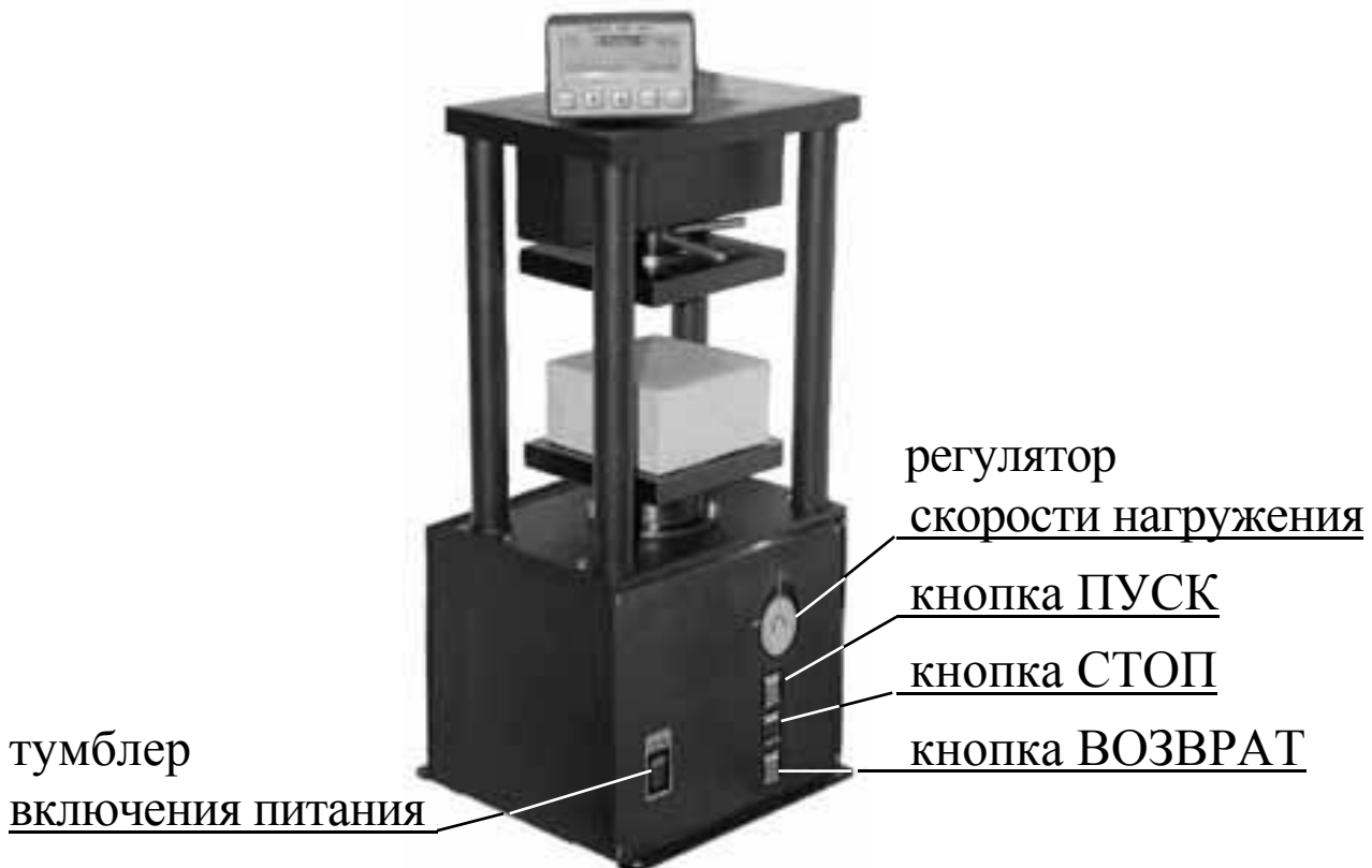
Рисунок 1.4.2.а. Общий вид лицевой части пресса ПМ-МГ4 с электрическим приводом механизма нагружения
