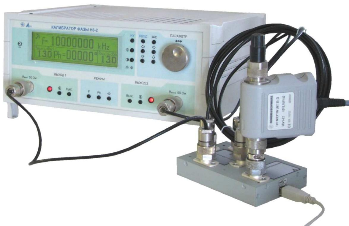
Рисунок 1 - Калибратор фазы Н6-2 с мостом измерительным МЕРА. 411625.006
