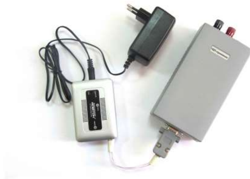
Рис. 4 – Подсоединение приемника для зарядки аккумуляторной батареи
