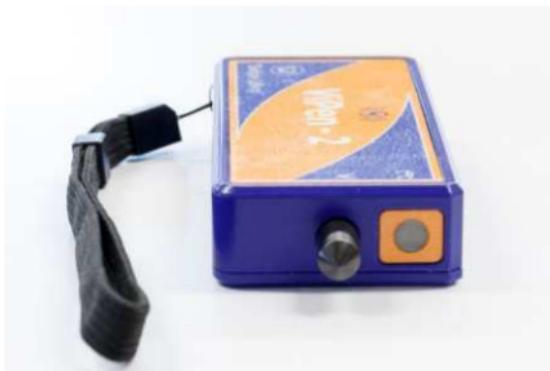
На заднем торце расположен светодиод, отображающий работу прибора. Он имеет три цвета:
