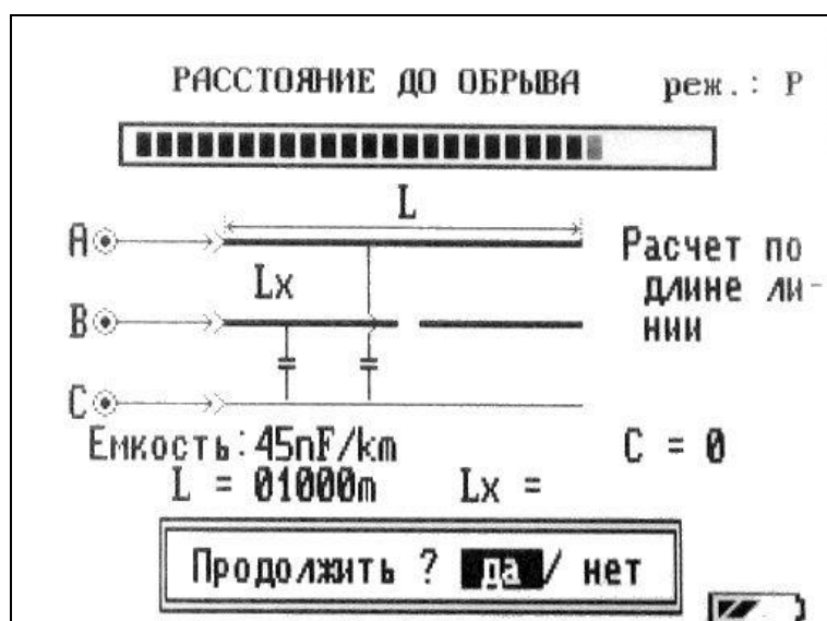
Рисунок 6-19 Определение расстояния до обрыва
