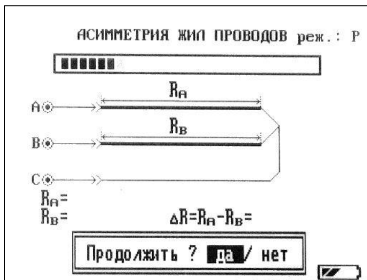
Рисунок 6-16 Измерение асимметрии жил проводов
