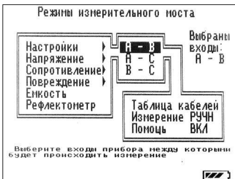
Рисунок 6-13 Выбор способа подключения кабеля к клеммам
