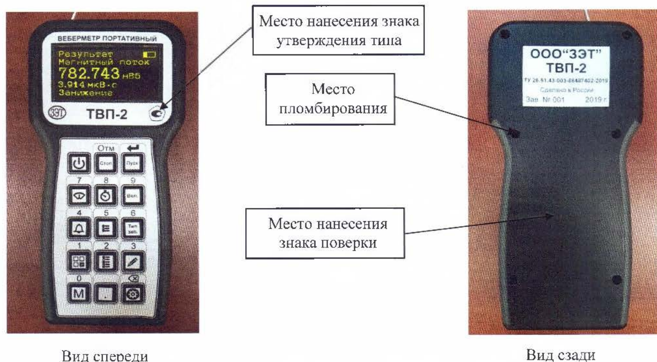
Рисунок 1 – Общий вид средства измерений, схема пломбировки от несанкционированного доступа, обозначение места нанесения знака поверки
