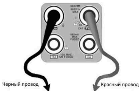
Рис.3.1-1 Подключение измерительного щупа к тестеру.
