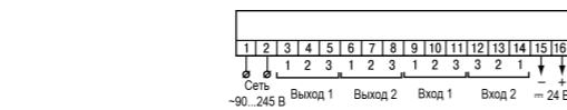
Рисунок 10 – Назначение контактов клеммной колодки прибора в настенном Н и щитовом Щ1, Щ2 типах корпусов
