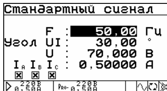
Рисунок 4.5. Окно задания параметров стандартного сигнала
