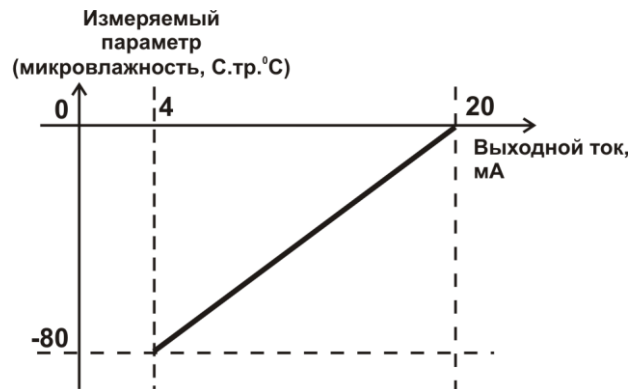
Рисунок 3.14 Линейный выход 4...20 мА по диапазону влажности от минус 80 до 0 °С по точке росы
