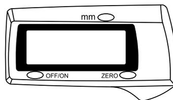
OFF/ON – включает и выключает прибор. Прибор отключится автоматически через 5 минут простоя.
