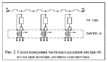
На рисунке 2 показана такая измерительная схема, которая регистрирует импульсы частичных разрядов при помощи встроенных датчиков температуры типа Pt100. Для простоты на рисунке показана только одна фаза обмотки статора «А-Х», состоящая из 6 секций. Датчик частичных разрядов марки «DRTD-3» включается в разрыв проводов, идущих от Pt100 к приборам измерения температуры.
