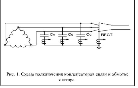
частичных разрядов в обмотки изоляции статора. Самая простая схема установки четырех датчиков приведена на Основную рисунке 1. роль здесь и рают специальные эпоксидно слюдяные конденсаторы связи. обозначенные на схеме «CABC». Конденсаторы устанавливаются внутри корпуса статора электрической машины, И подключаются К клеммам обмотки. Эти
