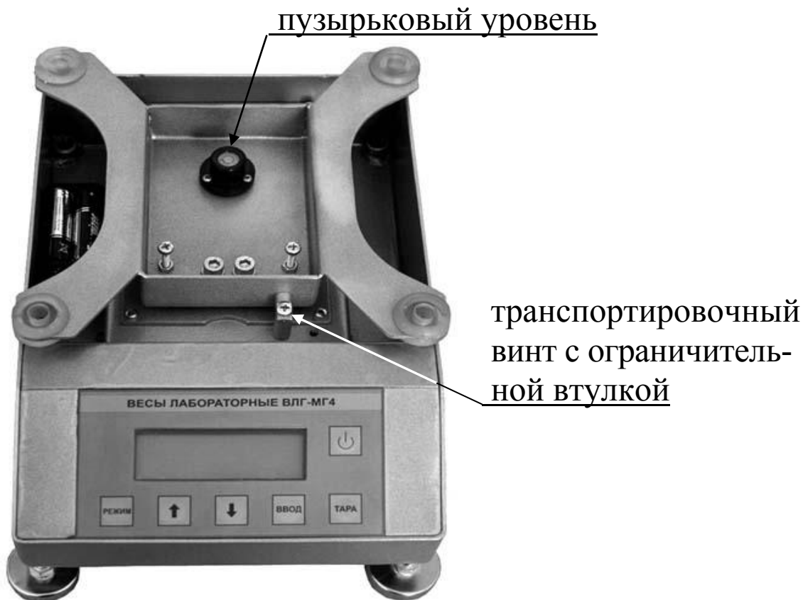
Рисунок 4 – Вид весов ВЛГ-МГ4, ВЛГ-МГ4.01 с НПВ от 5000 г со снятой платформой
