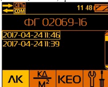
Рис.А.2.3.4.6-2. Индикация сохраненных в памяти БОИ-01 трёх сессий, измеренных с помощью еЛайт03 (ФГ) с заводским номером № 02069-16.
