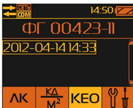
Рис.А.2.3.6.7-3. Выбор сессии для просмотра результатов измерения КЕО, записанных в памяти БОИ-01.
