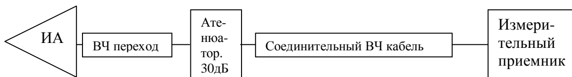
Рисунок 2 - Схема соединения при использовании комплекта в ручном режиме с использованием аттенюатора на 30 дБ или усилителя малозумящего для расширения динамического диапазона измерений излучений ИРП (ВЧ переход выполнен в виде короткого отрезка кабеля с разъемами типа вилка на обоих концах)
