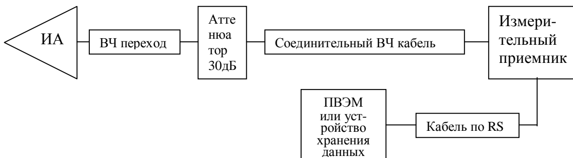
Рисунок 4 - Схема соединения при использовании комплекта в автоматизированном режиме при расширении динамического диапазона измерений
