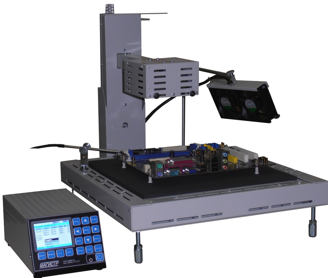
Фото 2. Общий вид станции с нижним термостолом
