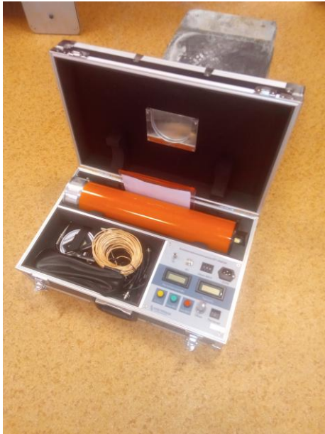
Высоковольтный блок испытания выпрямленным напряжением со встроенным контролем тока утечки, расчетом коэффициента нелинейности, защитой от перегрева обмоток. ИПТ-60/3
