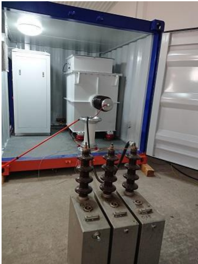
Высоковольтный отсек с резонансным реактором, делителем напряжения, шаровым разрядником и блоком выпрямленного напряжения
