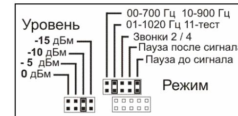
Для настройки параметров автоответчика служат два поля перемычек, доступ к которым осуществляется после снятия задней крышки автоответчика (нумерация позиций каждого из полей перемычек начинается со стороны телефонного соединителя, а их назначение приводится на этикетке):
