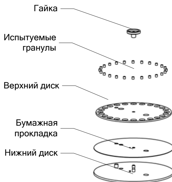
Рисунок 6 – Сборка кассеты
