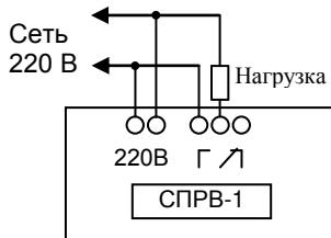
Подайте питание на реле. Для предварительной зарядки аккумулятора оставьте реле включенным в сеть на время не менее 8 час.
