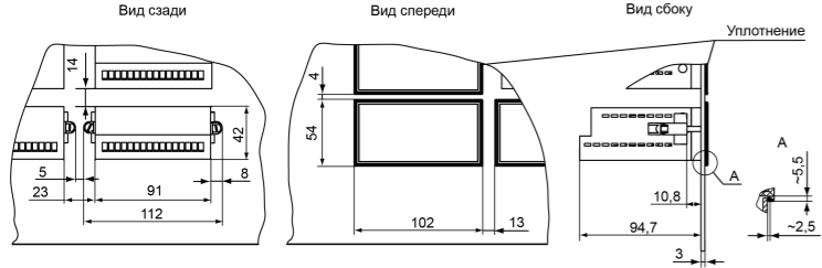
Рисунок 5 – Прибор в корпусе Щ2, установленный в щит толщиной 3 мм
