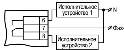
Рисунок 12 – Схема подключения нагрузки к ВУ типа «Р»
