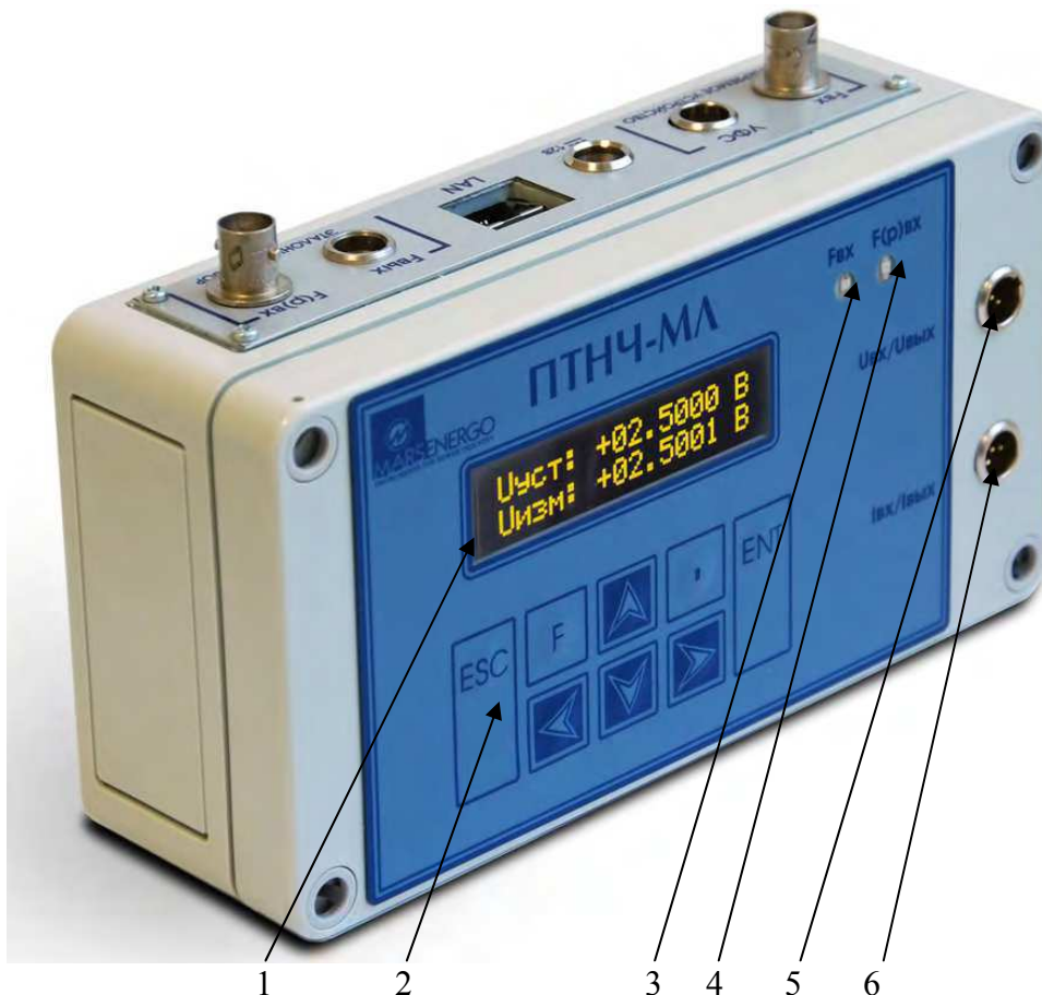
1 – буквенно-цифровой дисплей; 2 – клавиатура; 3 – светодиод индикации импульсов на входе "Fвх"; 4 – светодиод индикации импульсов на входе "F(р)вх"; 5 – соединитель "Uвх/Uвых" - вход или выход сигнала напряжения постоянного тока; 6 – соединитель "Iвх/Iвых" - вход или выход сигнала постоянного тока.
