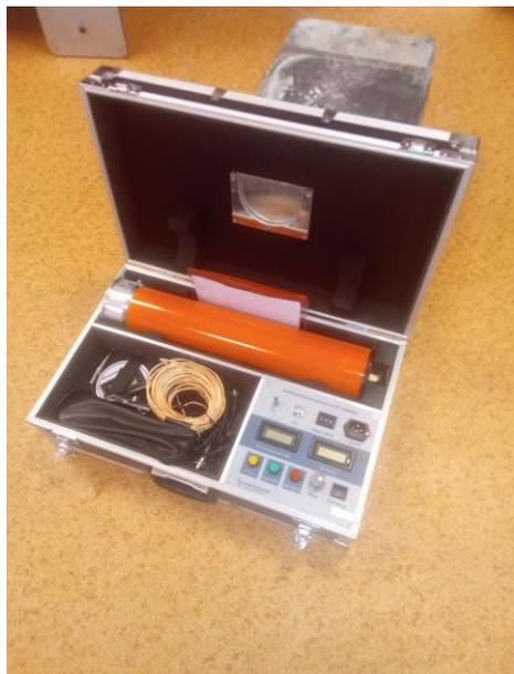
**Высоковольтный блок испытания
