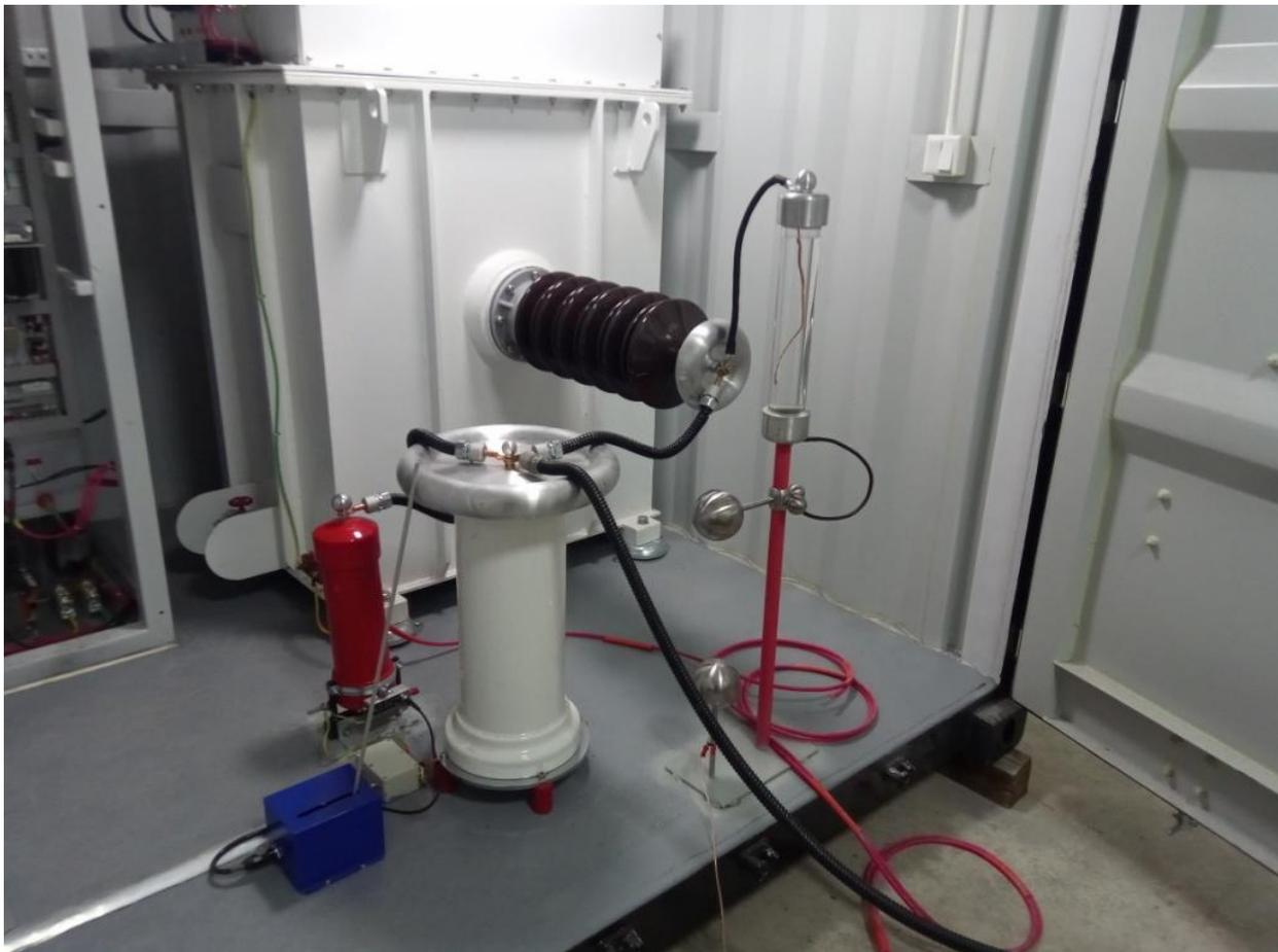
Высоковольтный отсек с резонансным реактором, резонансным конденсатором, делителем напряжения, шаровым разрядником, токоограничивающим резистором, заземлителем высоковольтного выхода электромеханическим.
