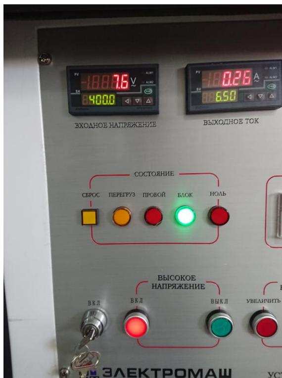
Пульт управления и измерения в низковольтном отсеке (автоматический (опция) или вариант с ручным управлением)
