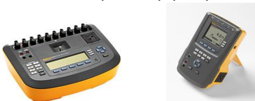
Рисунок 1 - Фотография общего вида анализаторов электробезопасности ESA 612, ESA 620
