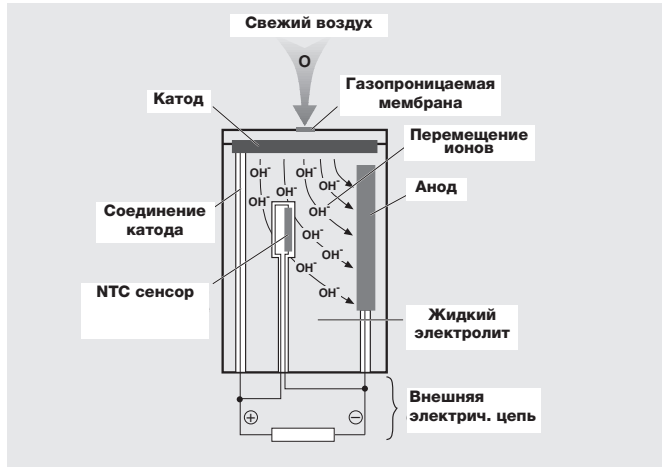
Рис. 27: Принцип работы сенсора O_2
