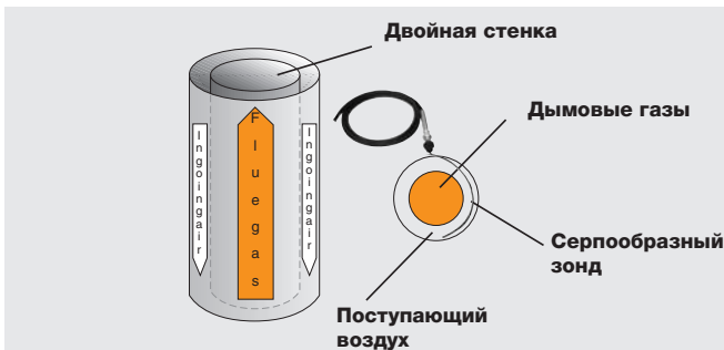
Рис. 20: Замер уровня O_2 в межстенном пространстве дымохода
