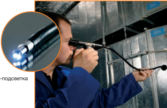
Рис. 22: Инспекция теплоизоляции с помощью эндоскопа testo 319
