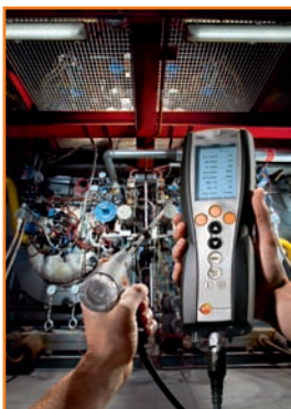
Рис. 19: Testo 340: многокомпонентный анализатор дымовых газов с возможностью прямого измерения \text{NO}_x
