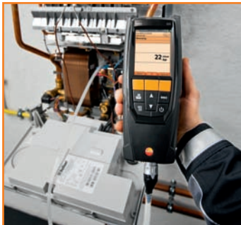
Измерение и регулировка давления газа в системе спомощью testo 320 и подключенного к нему комплекта для измерения диф. давления.
