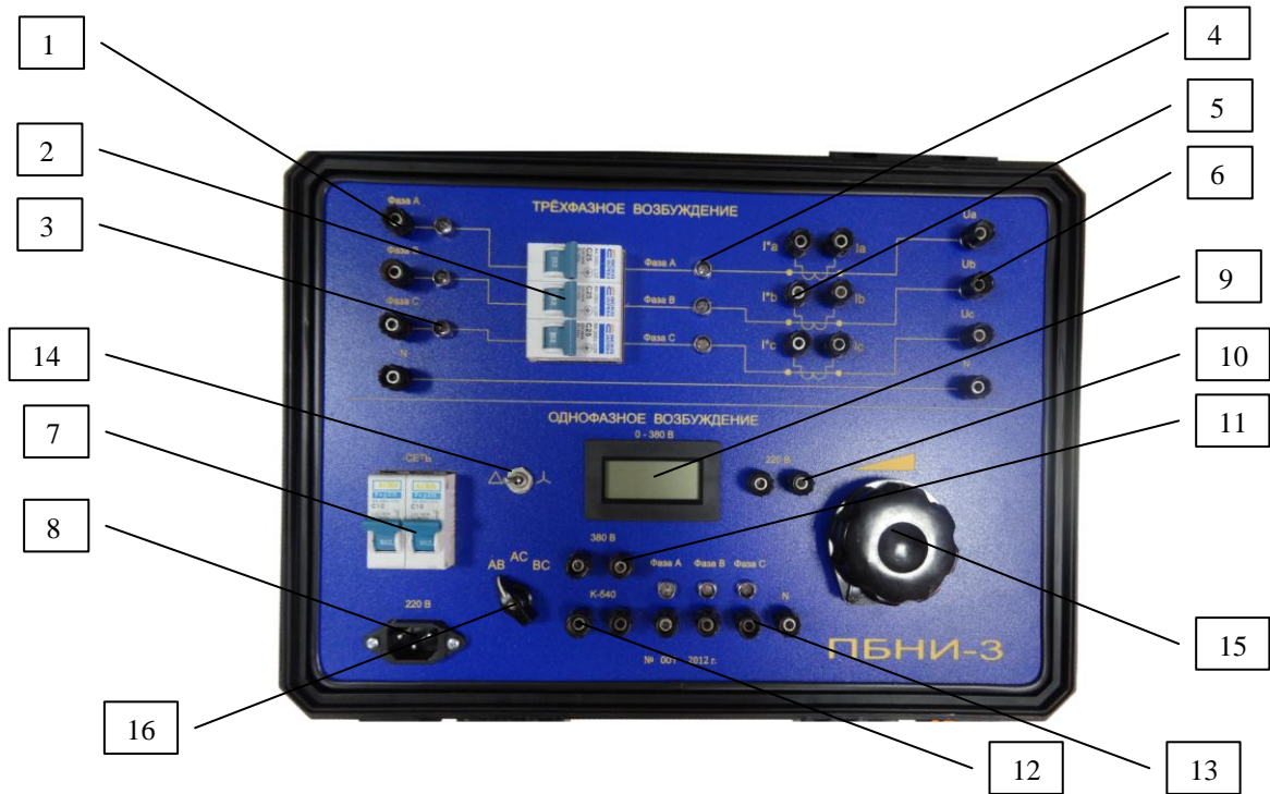
Рис. 1. Блок низковольтных измерений ПБНИ-3. Внешний вид лицевой панели.
