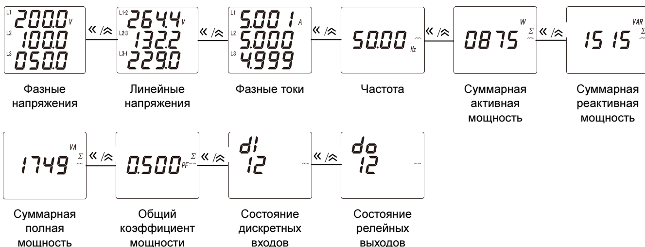
Рисунок 4.2 – Индикация показаний на приборе исполнения на DIN-рейку с ЖК-индикатором, дискретными входами и релейными выходами
