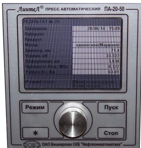
Автоматический расчёт дополнительных характеристик (предел прочности, работа на разрушение и т.п.) по нескольким результатам
