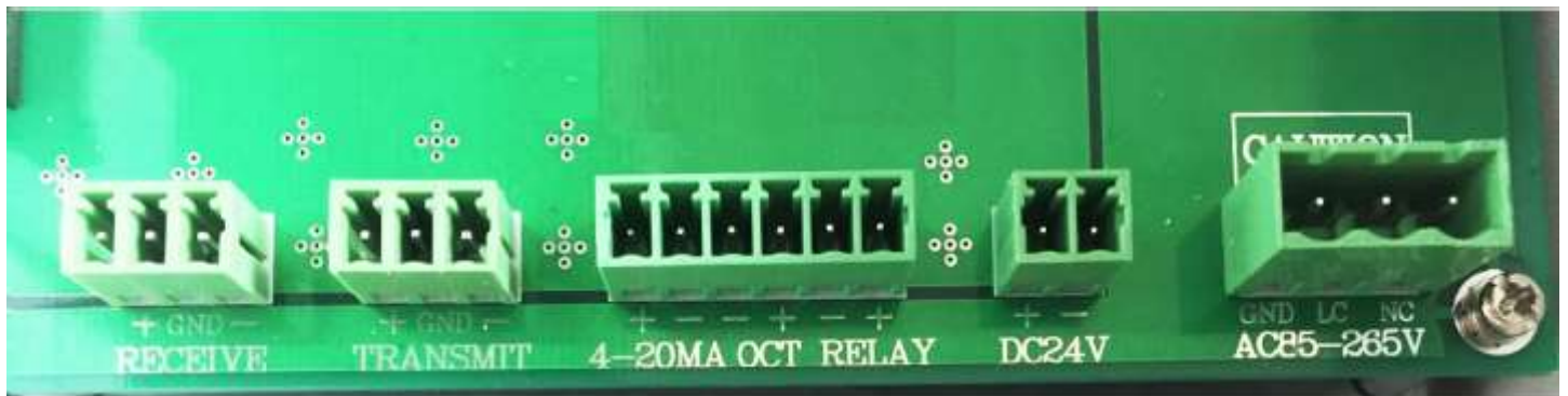
Рис. 2.3 Коммутационные разъемы электронного блока
