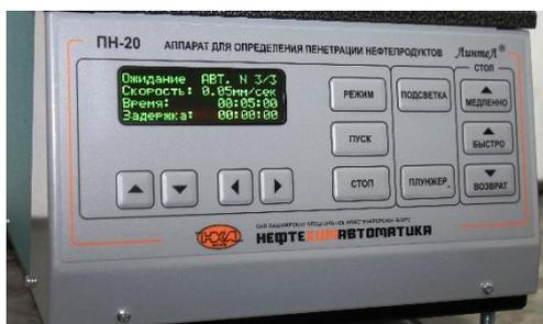
Отображение на дисплее в режиме ожидания: номера последнего проведенного испытания; заданного количества испытаний; скорости медленного подъема стола; заданного времени пенетрации; заданного времени задержки
