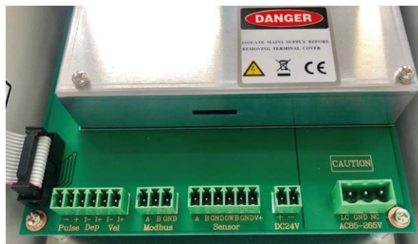
Схема подключения настенного вычислителя
