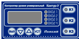
Лицевая панель контроллера «Контур-У-Щ1»
