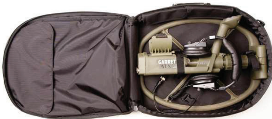
Рисунок 4: АТХ с подсоединённой катушкой Deerseeker + наушники. Лямки охватывают нижнюю штангу и корпус устройства.
