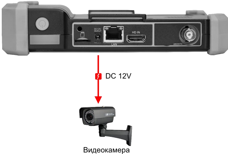
Рис. 8 Подключение питания к IP-видеокамере
