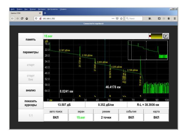
Гамма ЛЮКС – это полнофункциональный современный оптический рефлектометр, обладающий широким набором стандартных для OTDR функций, как у большинства мировых лидеров (Yokogawa, Viavi, EXFO) а также удобными специфичными функциями.
