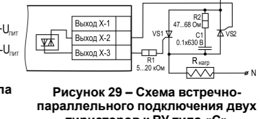
Рисунок 29 – Схема встречно-параллельного подключения двух тиристоров к ВУ типа «С»
