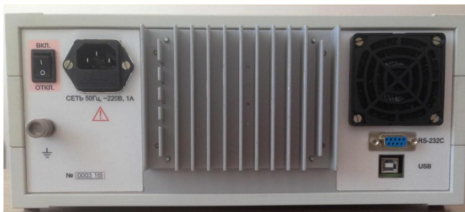
Рисунок 2 - Задняя панель измерителей разности фаз Ф2-41
