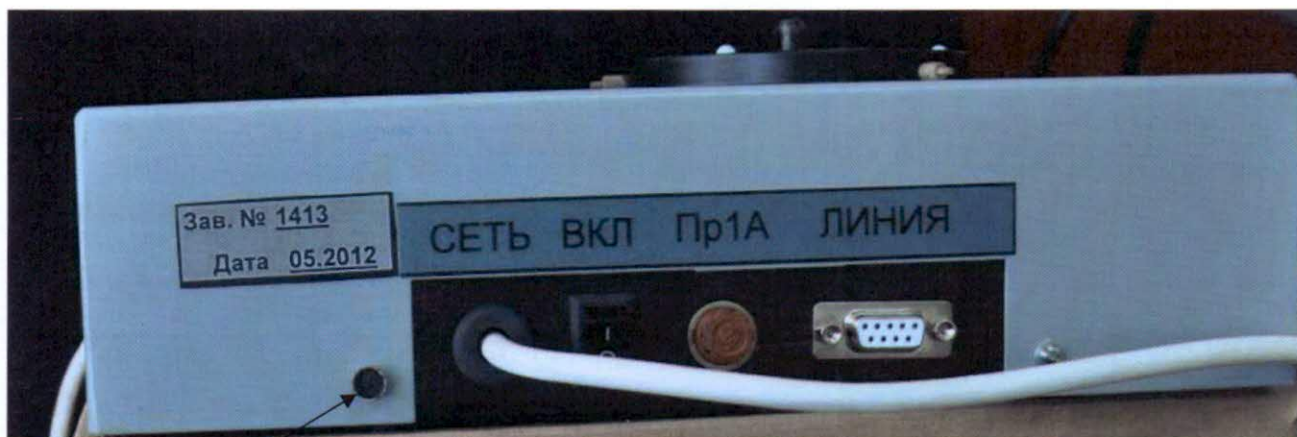
Рисунок 1 – Общий вид белизномеров с обозначением места нанесения знака поверки и маркировки
