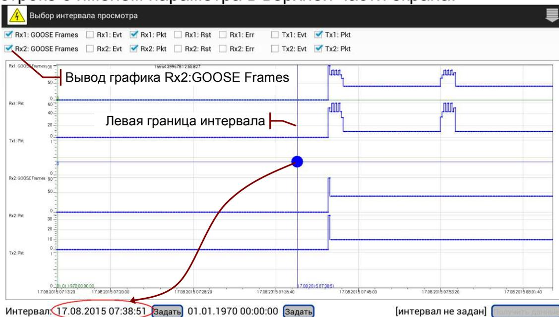
Графики позволяют определить интервал времени, содержащий интересующее событие: изменение состояния, обнаружение ошибок, всплеск активности.
