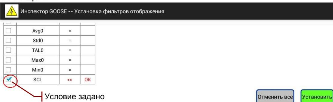
Кнопка «Установить» в нижней части экрана обеспечивает применение фильтра:
