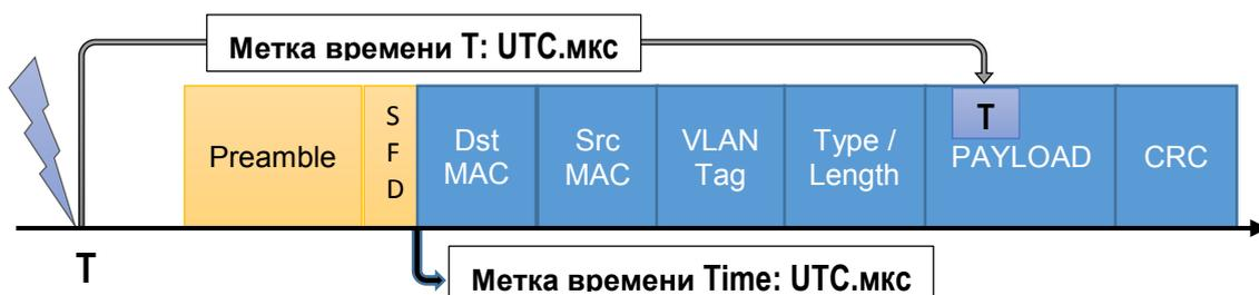
Высокое быстродействие сетевого стека анализатора обеспечивает близость значений метки времени **T** и метки времени передачи **Time** при публикации сообщения с **SqNum = 0**.
