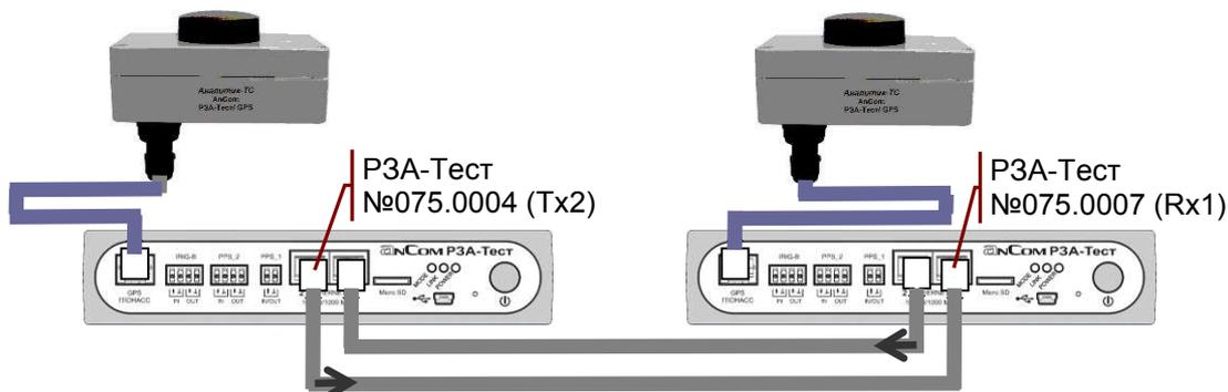
Анализатор использует **собственное** время публикации Src-сообщения для вычисления задержки приема Dst-сообщения. Синхронизация времени и идентичность последовательности публикации обеспечивают совпадение моментов отправления Src-сообщений двух анализаторов.
