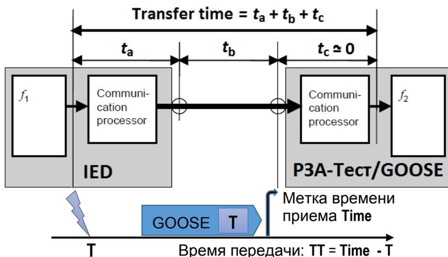
Данный метод позволяет оценить время передачи в случае достаточно точной синхронизации времени IED-устройства и отсутствия задержки внутреннего scan-цикла.
