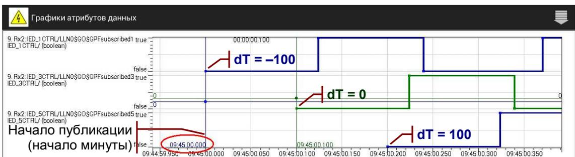
Измерение задержки двумя анализаторами может потребовать установки согласованного времени (UTC) в поле «Время начала публикации: дата время».
