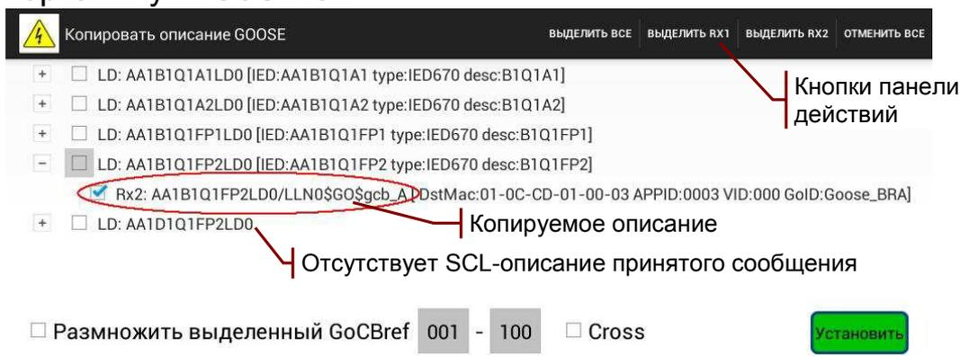
В списке можно отметить порты нескольких сообщений с помощью кнопок на панели действий. Отмеченные таким образом сообщения копируются при нажатии на «Установить».
