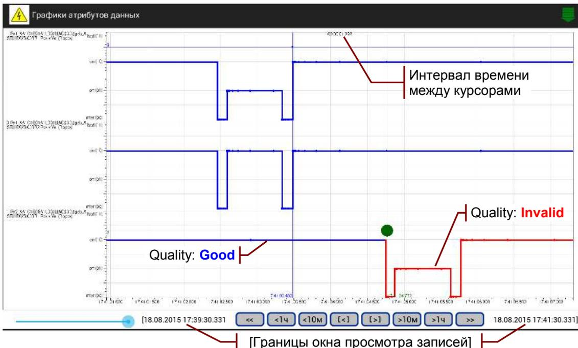
Ползунок соответствует положению правой границы окна просмотра записей, размер окна фиксированный, равен 2 мин. Кнопки позиционирования перемещают окно просмотра по временной оси диаграммы:
