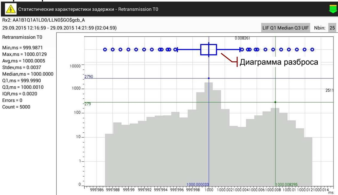
Верхняя строка содержит порт и GoCBRef принимаемого Dst-сообщения, отправляемого Src-сообщения<sup>1</sup> а также время начала и продолжительность интервала времени, на котором определялись характеристики задержки. Левая часть содержит имя параметра и значения статистических характеристик.
