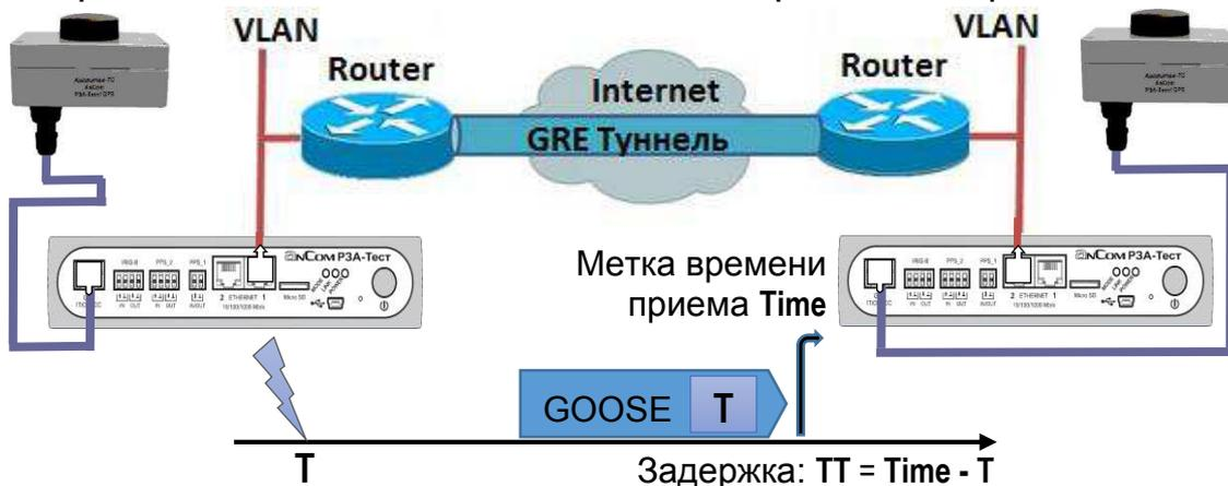
Данный метод обеспечивает, например, измерение задержек передачи GOOSE-сообщений по IP-туннелю. Публикацию сообщений с заданной интенсивностью и всплесками активности обеспечивает анализатор на удаленной стороне.
