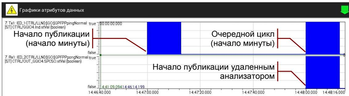
Способы измерения задержки передачи сообщений двумя анализаторами обсуждается в разделе 4.5.1.
