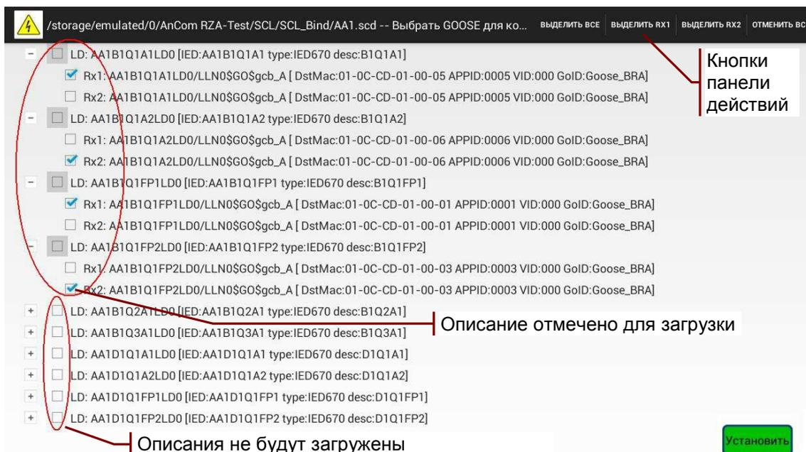
Каждому GOOSE необходимо назначить порты приема Rx1, Rx2 в соответствии с подключением к ETHERNET 1, 2. Кнопки панели действий позволяют назначить порты приема для всего списка GOOSE:
