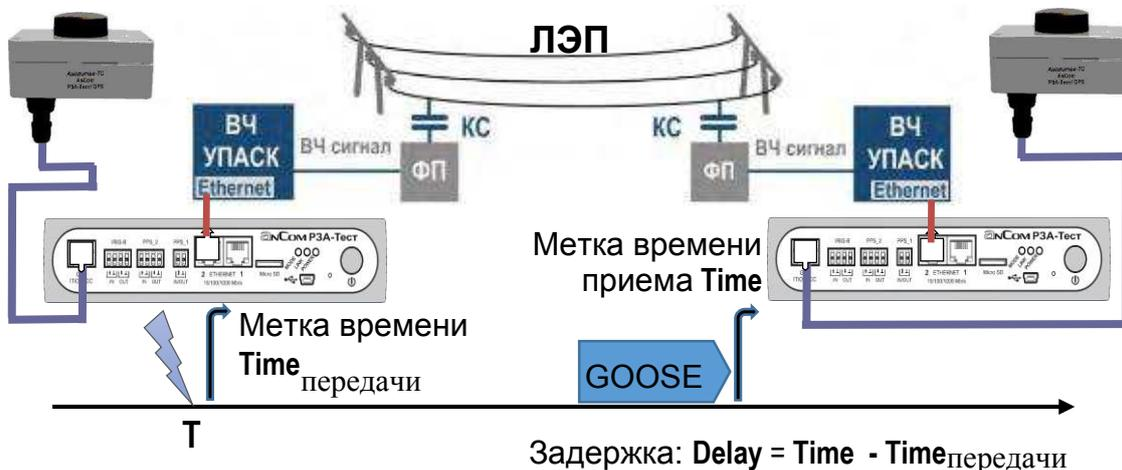
Данный метод позволяет оценить задержку передачи GOOSE по высокочастотному (ВЧ) каналу по линиям электропередачи (ЛЭП). Информационная часть сообщения преобразуется в кодируемые ВЧ сигналы, которые приемник устройства передачи аварийных сигналов и команд (УПАК) восстанавливает в виде GOOSE-сообщения. Преобразование не сохраняет значение метки времени T в структуре отправленного сообщения, что не позволяет оценить задержку по методу 1.
