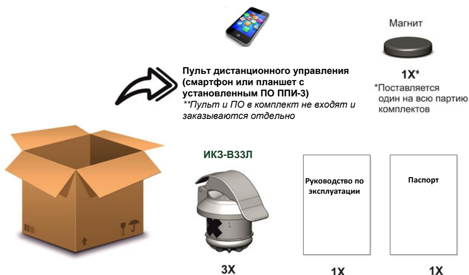
Рисунок 2 – Состав поставки комплекта индикаторов ИКЗ-В33Л-У3
