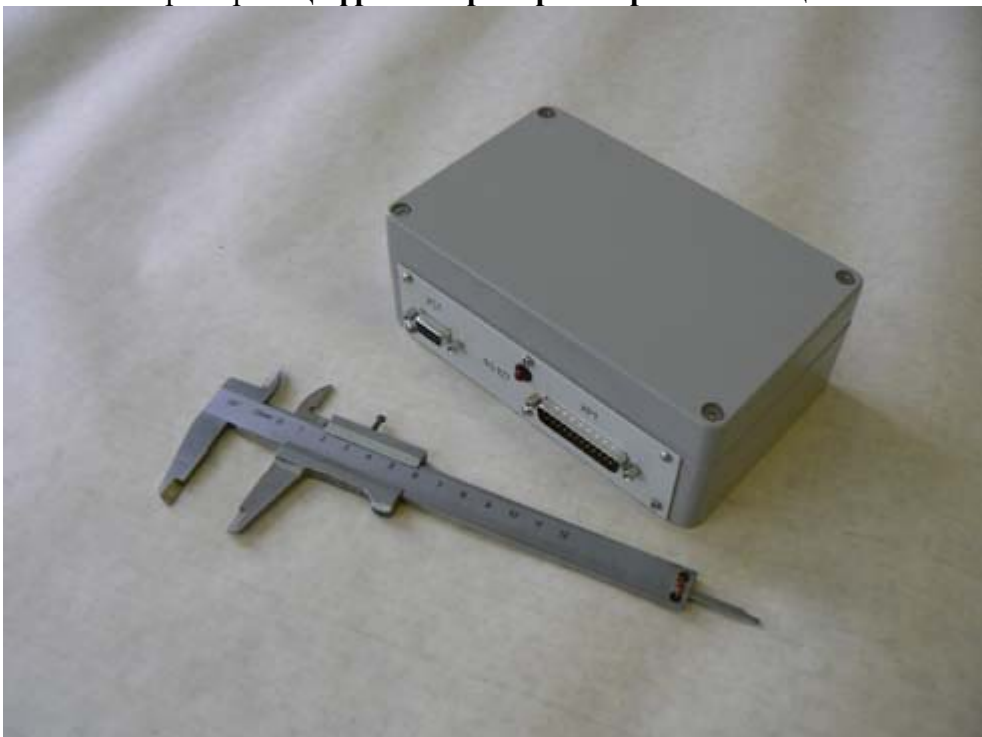
Пример 2. Цифровой прибор контроля изоляции
