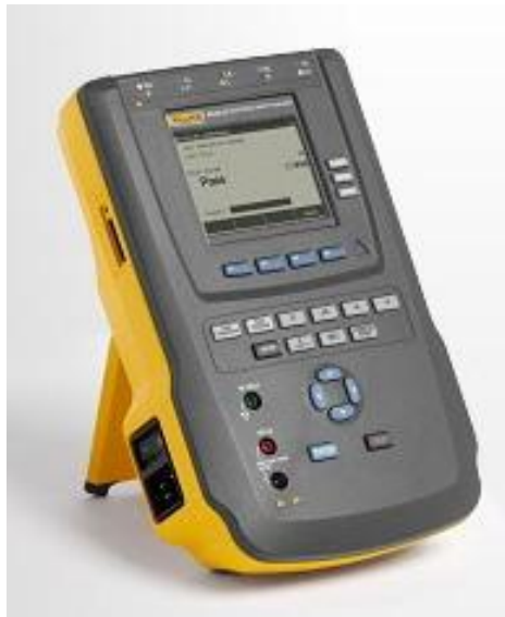
Рисунок 1 – Фотография общего вида анализаторов электробезопасности ESA 615
